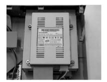
7. HDDブラケットが製品の内側にしっかりと取り付けられていることを確認した後、電源ケーブルと信号通信ケーブル (DEケーブル) をHDDに接続します。
